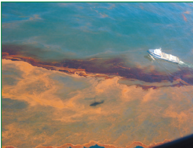
Figura 18: Sub-dosagem – aplicação de menos dispersante que o requerido, significa que a pulverização foi ineficaz. O óleo permanecerá na superfície no seu estado normal (Fonte: OSRL, 2011).
