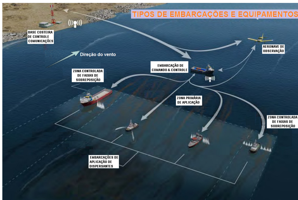
Figura 26: Tipos de navios e equipamentos que podem ser considerados em uma operação de aplicação de dispersante por via marítima (Fonte: Modificado a partir do original em BP, 2012).
